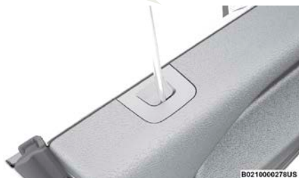
Coloque la herramienta en el orificio de servicio para quitar el tapón
