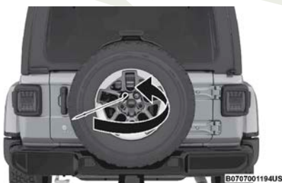
Desbloqueo de la cubierta de la cámara trasera
