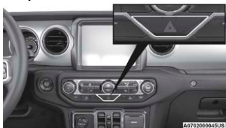
Interruptor de las luces de emergencia
