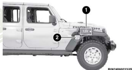
Ubicación de las baterías
