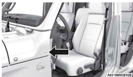
Ubicación del perno de la cubierta
