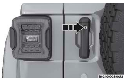
Ubicación de entrada pasiva de compuerta trasera
