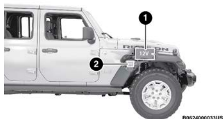
Ubicación de las baterías
