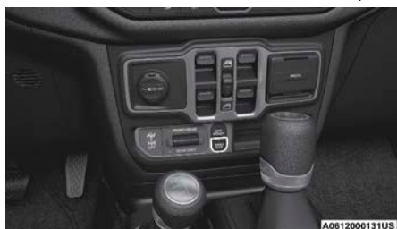
Interruptor de la barra estabilizadora
