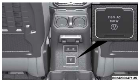
Inversor de corriente
