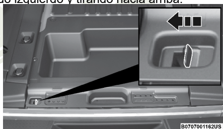
Seguro de la cubierta de almacenamiento de herramientas
