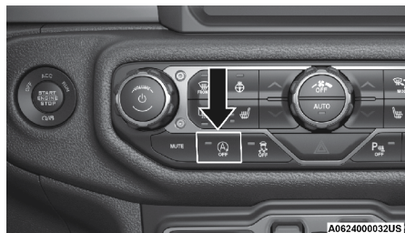
Interruptor de apagado del sistema de Paro/Arranque
