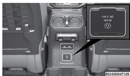
Inversor de corriente
