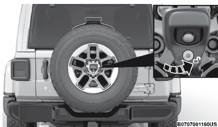
Desbloqueo de la cubierta de la cámara trasera
