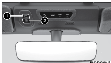
Interruptor de control del toldo deslizable
