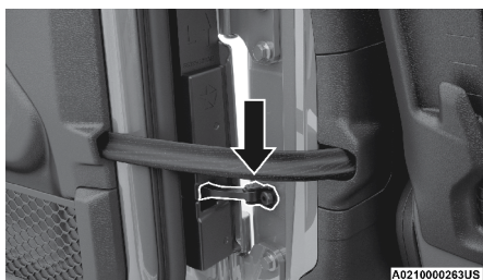
Retenedor de la puerta (enganchado)
