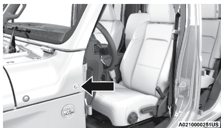
Ubicación del perno de la cubierta
