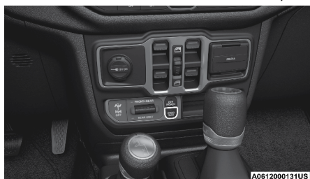
Interruptor de la barra estabilizadora
