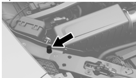
Ubicación del poste remoto negativo (-)
