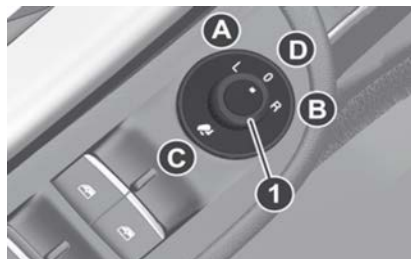
Control eléctrico del espejo
