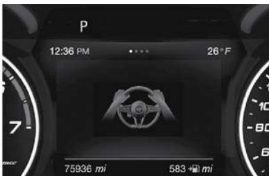
Pantalla de presencia de manos en el volante no detectada (hasta por 6 segundos)
