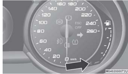
Medidor de nivel de combustible
