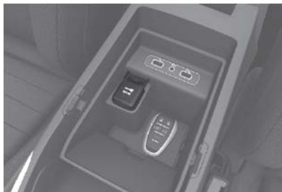
Toma de corriente
