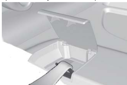
Ubicación de los anclajes para correa superior
