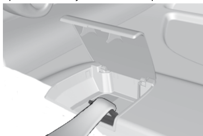
Ubicación de los anclajes para correa superior
