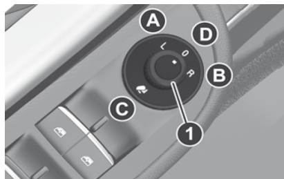
Control eléctrico del espejo
