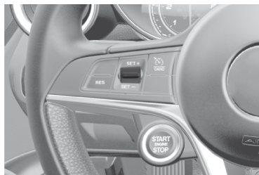
Interruptor SET del control de velocidad electrónico
