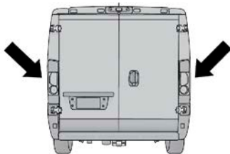
Ubicación de los sensores de radar
