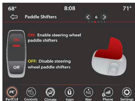
Paletas de cambio - Transmisión automática
