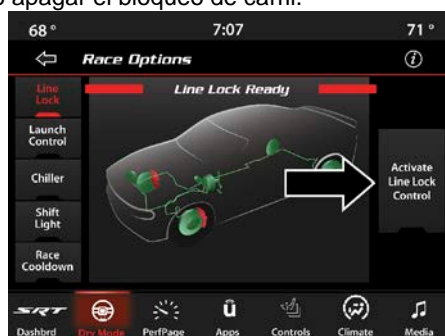
Activación del bloqueo de carril
