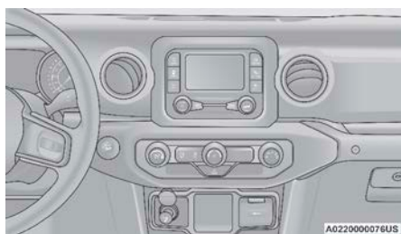
Controles de clima manual en Uconnect 3 con pantalla de 5"
