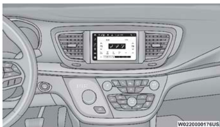
Controles de clima automático en Uconnect 5 con pantalla de 7"
