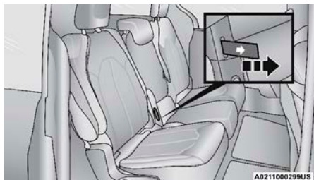
Correa de la segunda fila de asientos para doblar el octavo asiento
