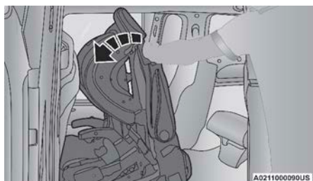
Asiento de fácil inclinación con silla de niño instalada
