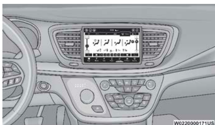
Controles de clima automático en Uconnect 5 con pantalla de 10.1"
