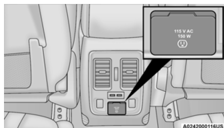
Inversor de corriente
