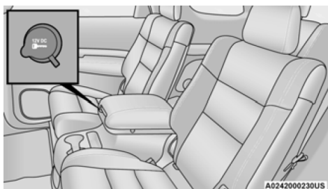
Toma de corriente de la consola central trasera
