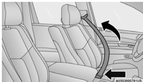
Eliminando holgura del cinturón de seguridad
