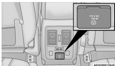
Inversor de corriente
