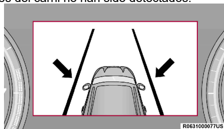
Sistema encendido (líneas grises)
