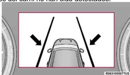
Sistema encendido (líneas grises)
