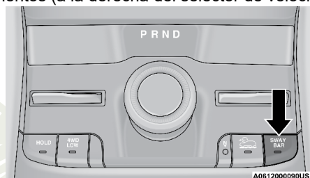
Interruptor de la barra estabilizadora
