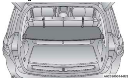
Cubierta del área de carga
