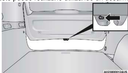
Liberación de servicio de la compuerta levadiza
