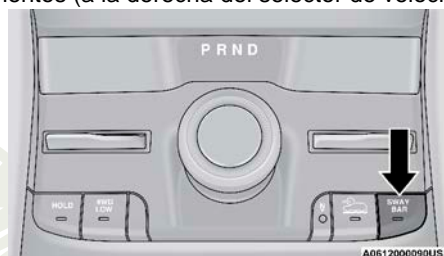
Interruptor de la barra estabilizadora
