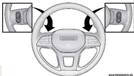
Controles de sonido detrás del volante
