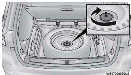
Reinstalación del sujetador de la llanta
