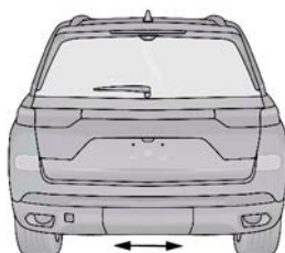
Zona de activación de la compuerta manos libres
