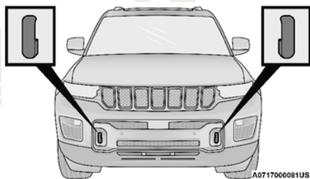
Ganchos para remolque frontales
