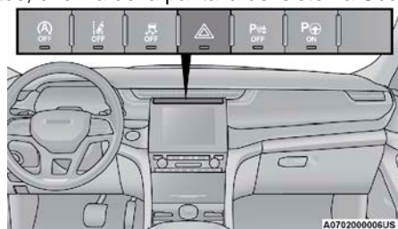
Interruptor de las luces de advertencia/intermitentes
