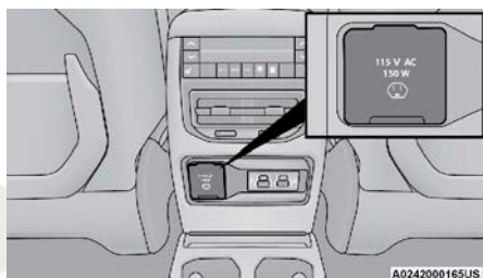
Inversor de corriente
