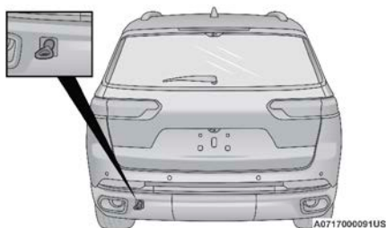
Argolla trasera instalada
