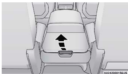
Palanca de liberación trasera
