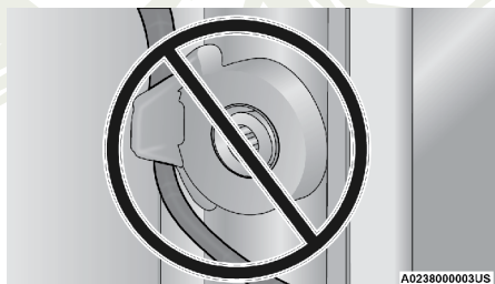
Cable de la compuerta trasera asentado incorrectamente
