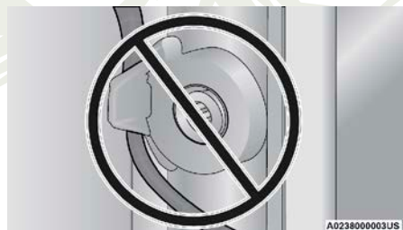
Cable de la compuerta trasera asentado incorrectamente
