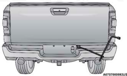
Coloque la extensión de tubo dentro del acceso
