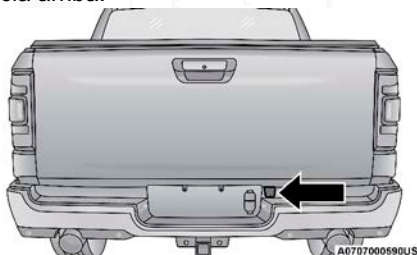
Cubierta protectora del acceso
