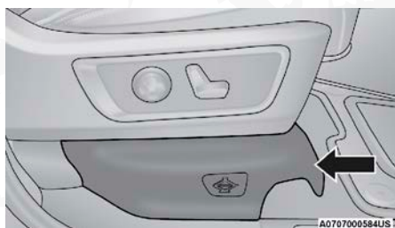
Cubierta de acceso al gato
