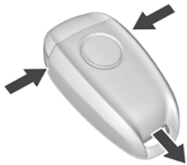
Retiro de la cubierta del transmisor
