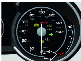
Medidor de nivel de combustible
