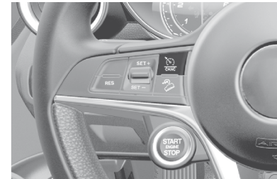
Botón de apagado/encendido del control electrónico de velocidad de cruceo
