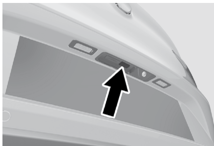
Interruptor externo de liberación de compuerta trasera
