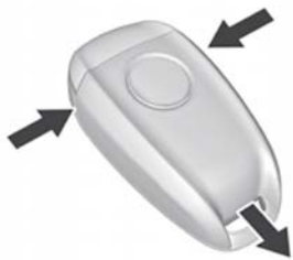
Retiro de la cubierta del transmisor
