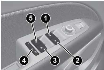
Interruptores de las ventanas
