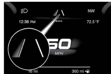
Acercamiento a la línea de carril
