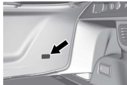
Ubicación del liberador de la compuerta levadiza
