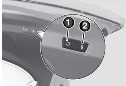
Interruptores de bloqueo/compuerta trasera
