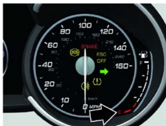
Medidor de nivel de combustible
