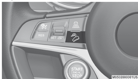
Interruptor del HDC
