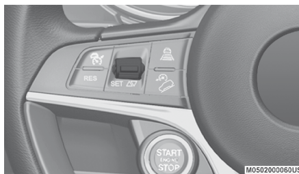
Interruptor SET para velocidad del HDC
