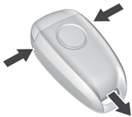
Retiro de la cubierta del transmisor
