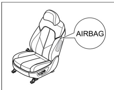
Las bolsas de aire laterales delanteras se encuentran al interior del asiento en el costado externo del conductor y pasajero (área sombreada con línea punteada), indicadas con la leyenda “AIRBAG”.
