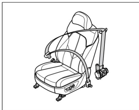
Al ocurrir una colisión, se debe llevar correctamente el cinturón de seguridad para que pueda sujetar a los pasajeros en el vehículo en una posición adecuada, mitigando la inercia del movimiento hacia delante, evitando movimiento incontrolado de pasajero/conductor y ser expulsado, al mismo tiempo, les ofrece la mejor protección de la bolsa de aire, reduciendo al máximo los daños del impacto.
