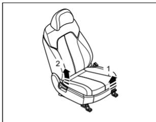
Para deslizar los asientos hacia delante o hacia atrás:
