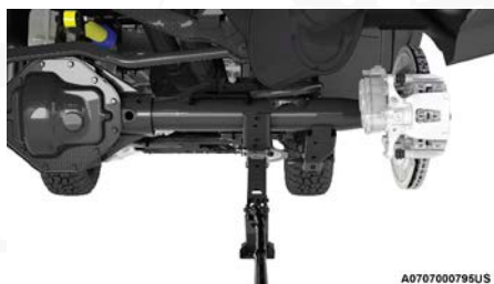
Colocación del gato en la parte trasera
