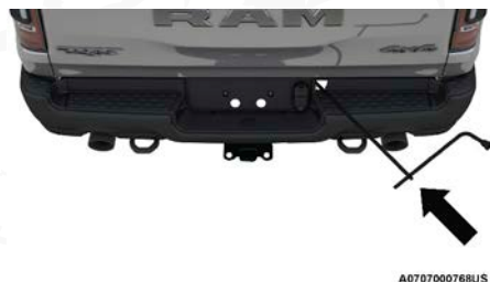
Introduciendo la extensión del tubo al orificio de acceso
