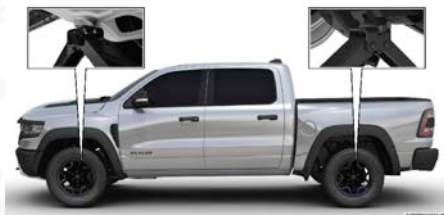
Colocación del gato
