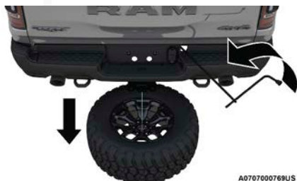
Retirando la llanta de refacción
