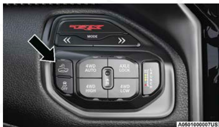
Interruptor de control de selección de velocidad
