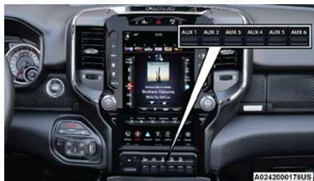
Ubicación de los interruptores auxiliares
