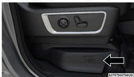
Cubierta de acceso al gato
