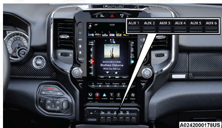
Ubicación de los interruptores auxiliares
