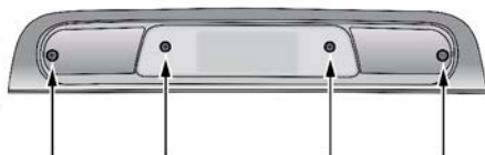
Ubicación de tornillos de montaje de la CHMSL
