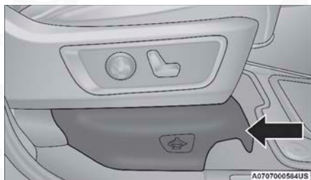
Cubierta de acceso al gato
