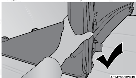
Doblado correcto - Mantenga los paneles juntos
