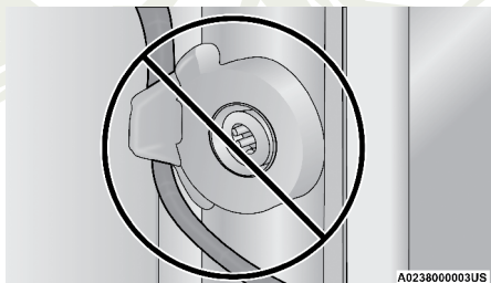
Cable de la compuerta trasera asentado incorrectamente
