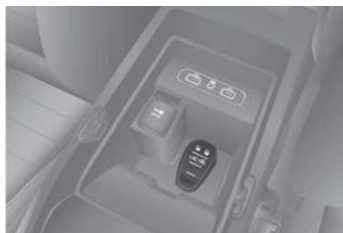
Ubicación para la colocación del transmisor
