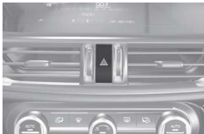
Interruptor de las luces de emergencia
