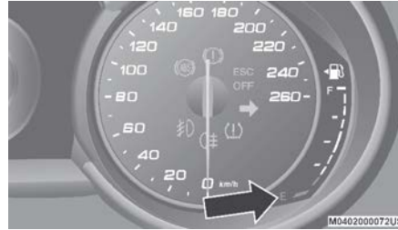
Medidor de nivel de combustible
