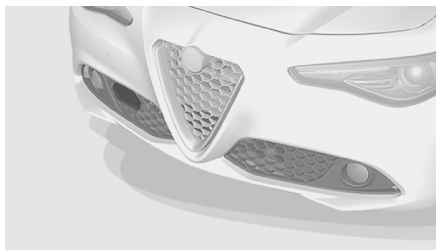
Ubicación del radar en la defensa delantera
