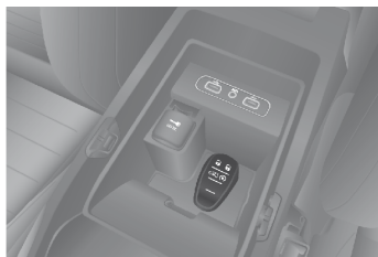
Ubicación para la colocación del transmisor
