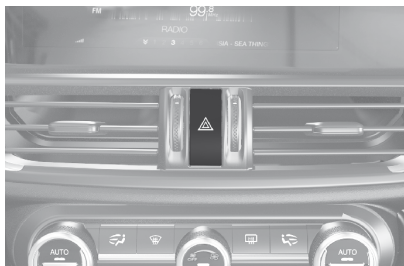
Interruptor de las luces de emergencia
