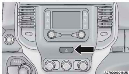
Interruptor de las luces de emergencia
