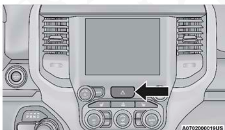
Interruptor de las luces de emergencia
