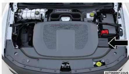
Centro de distribución de energía (fusibles)
