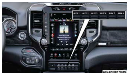
Ubicación de los interruptores auxiliares
