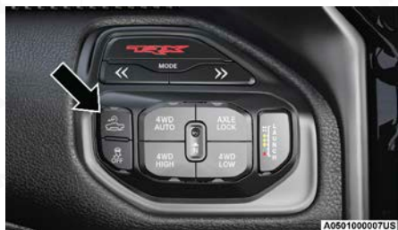
Interruptor de control de selección de velocidad
