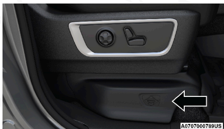
Cubierta de acceso al gato
