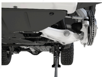
Colocación del gato en la parte delantera
