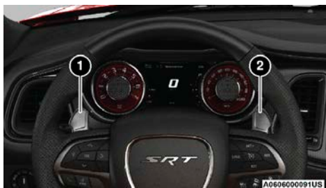
Paletas de cambio al volante
