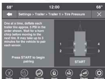
Ajustes del sistema de monitoreo de presión de llanta de remolque
