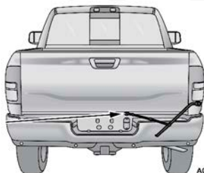
Insertando los tubos de extensión en el agujero de acceso
