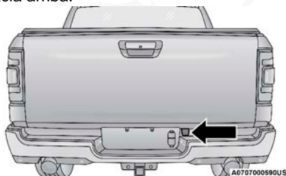
Cubierta protectora del acceso
