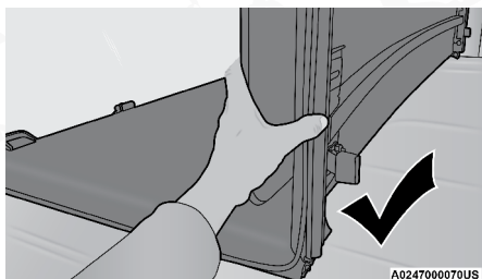
Doblado correcto - Mantenga paneles juntos
