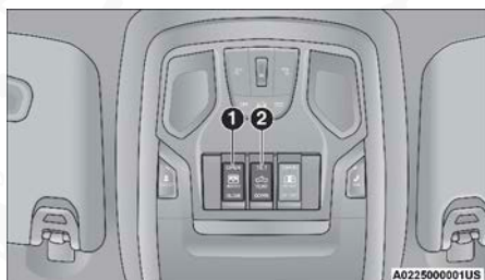
Interruptor del toldo solar
