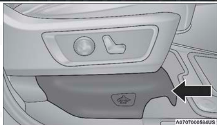
Cubierta de acceso al gato
