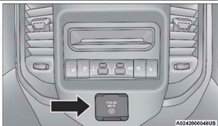
Toma de inversor de corriente de la consola central trasera
