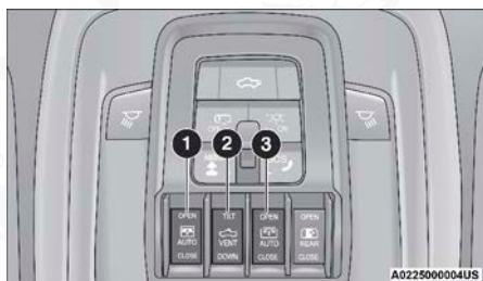
Interruptor del toldo solar
