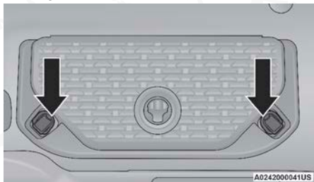
Ganchos del compartimiento de almacenamiento
