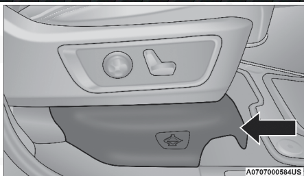
Cubierta de acceso al gato
