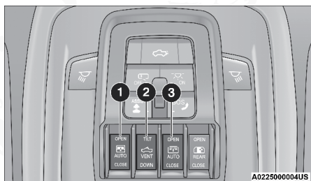
Interruptor del toldo solar
