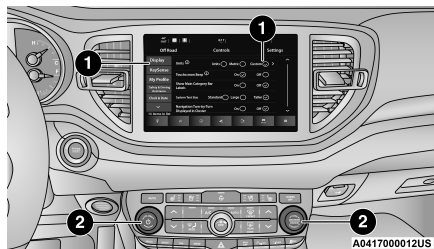
Botones en la pantalla y en el tablero Uconnect® 5/5 NAV con pantalla de 10.1"
