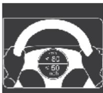
Inmediatamente después de haber inyectado el sellador y haber inflado la llanta, conduzca el vehículo por un lapso de 8 km (5 millas) o 10 minutos para permitir una correcta distribución del sellador en toda la llanta. No exceda los 80 km/h (50 mph).
