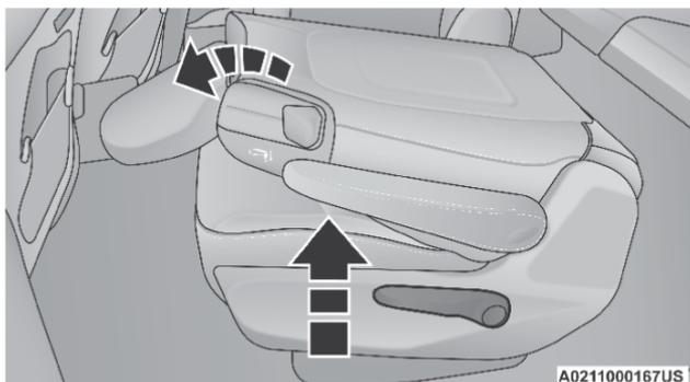
Levante la palanca de inclinación y pliegue el respaldo plano
