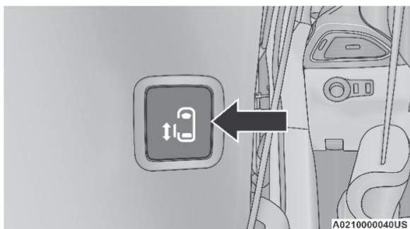
**Interruptor de la puerta deslizable eléctrica del lado del conductor**
