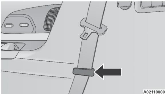
**Clip de sujeción del cinturón de seguridad**
