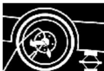
3. Instale la llanta de refacción inflable como se describió anteriormente en este manual. Asegúrese que la válvula de inflado de la llanta se encuentre cerca del piso, y luego enrosque la manguera del compresor a la válvula de inflado.
