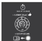
1. Continúe operando la bomba hasta que el sellador ya no esté fluyendo a través de la manguera (normalmente toma de 30 a 70 segundos). Como el sellador vaya fluyendo a través de la manguera, el indicador de presión bajará de aproximadamente 70 psi (4.8 bar) a la presión de la llanta cuando la botella de sellador este vacía.
