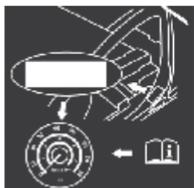
2. La bomba comenzará a inyectar aire en la llanta inmediatamente después de que la botella de sellador este vacía. Continúe operando la bomba e infle las llantas a la presión indicada en la etiqueta de presión de llantas en el pilar del lado del conductor (presión recomendada). Verifique la presión de la llanta en el indicador de presión.
