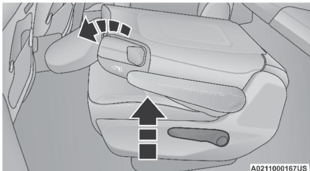
Levante la palanca de reclinación y pliegue el respaldo plano
