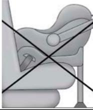
No instale una silla viendo hacia atrás usando un soporte trasero de piernas en el vehículo. El piso de este vehículo no está diseñado para manejar las fuerzas en caso de un choque con este tipo de asientos. En un choque, el soporte a las piernas no funcionará como fue diseñado y el niño podría salir severamente lastimado como resultado.
