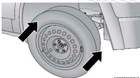
Montaje de la llanta de refacción compacta
