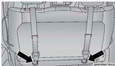
**Ubicación de los anclajes superiores de la segunda fila de asientos tipo banca**
