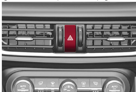
Interruptor de las luces de emergencia
