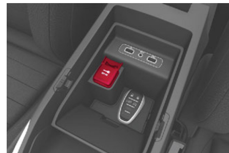
Inversor de corriente
