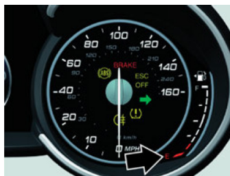
Medidor de nivel de combustible
