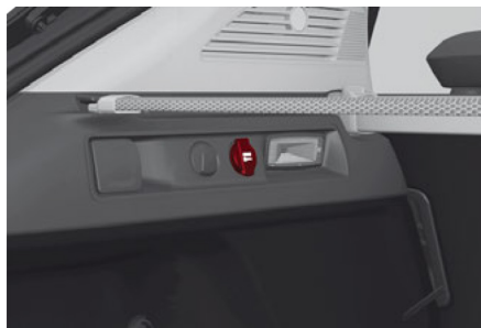
Toma de corriente del área de carga
