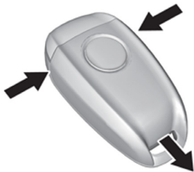
Retiro de la cubierta del transmisor
