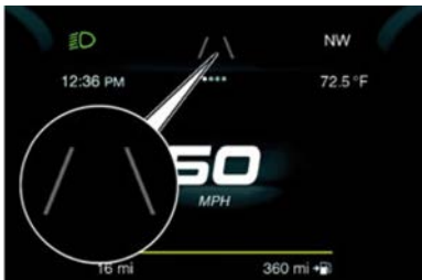
Líneas de carril no detectadas
