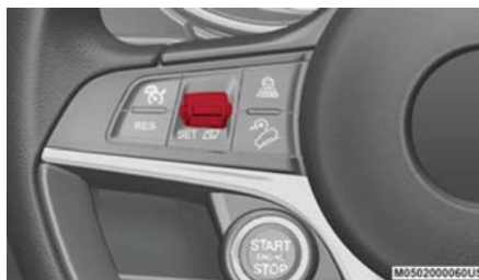
Interruptor SET para velocidad del HDC
