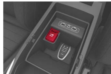
Inversor de corriente
