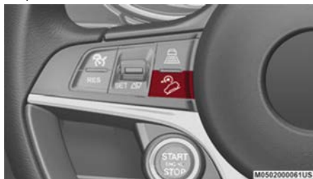
Interruptor del HDC
