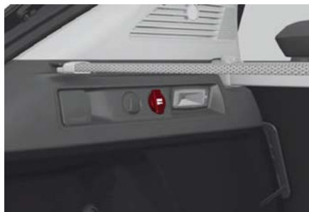
Toma de corriente del área de carga
