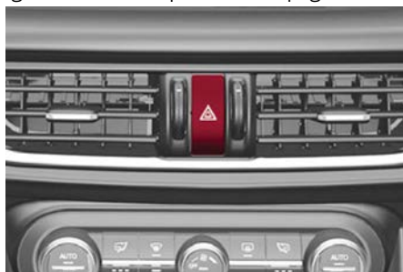
Interruptor de las luces de emergencia
