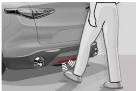
Zona de activación de la compuerta trasera
