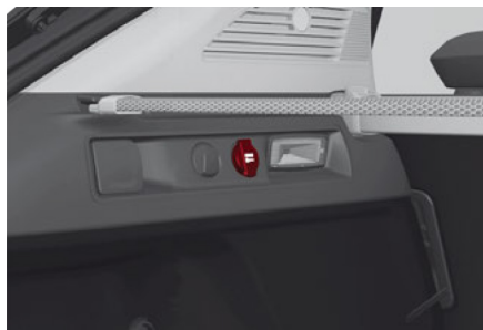
Toma de corriente del área de carga
