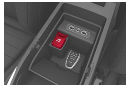
Inversor de corriente
