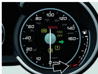
Medidor de nivel de combustible
