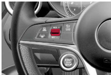
Interruptor SET del control de velocidad electrónico
