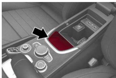
Superficie de carga inalámbrica
