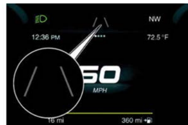
Líneas de carril no detectadas
