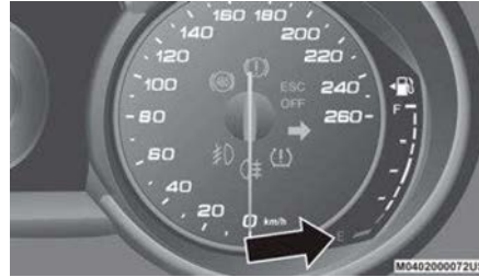
Medidor de nivel de combustible
