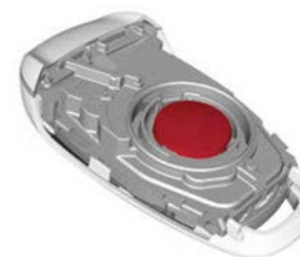
Ubicación de la batería
