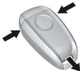
Retiro de la cubierta del transmisor
