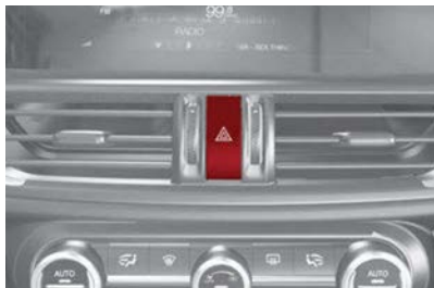
Interruptor de las luces de emergencia
