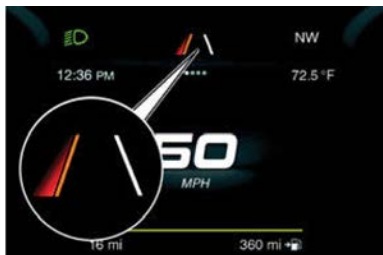
Acercamiento a la línea de carril
