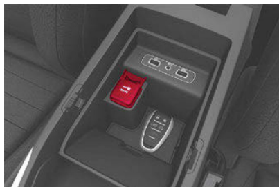
Toma de corriente
