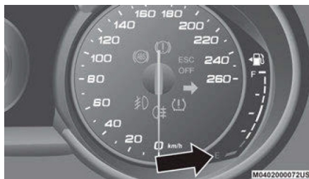
Medidor de nivel de combustible
