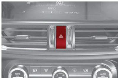
Interruptor de las luces de emergencia
