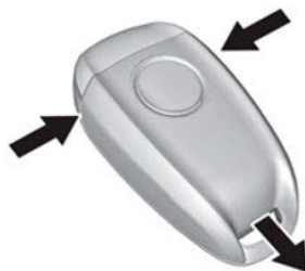
Retiro de la cubierta del transmisor
