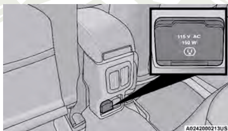
Ubicación del inversor de corriente
