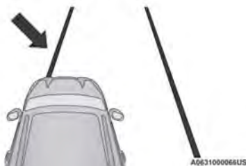
Línea cruzada (Línea amarilla destellando)
