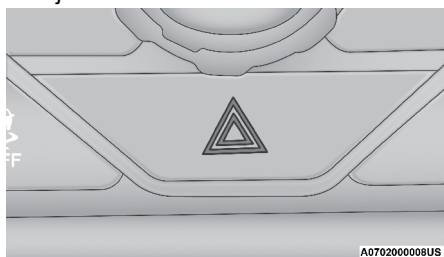
Interruptor de las luces de emergencia
